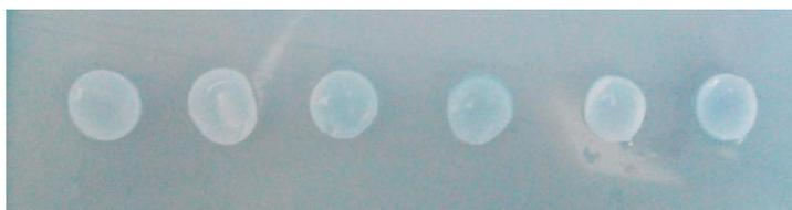
Рис. 3. Образцы свежеприготовленных гепарин-конъюгированных фибриновых гидрогелей
