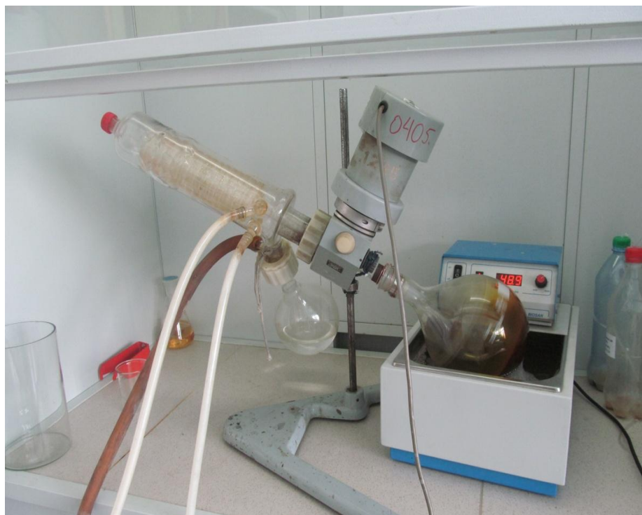
Рис. 4. Отгонка этанола после ферментации сиропа из стеблей сорго сахарное
